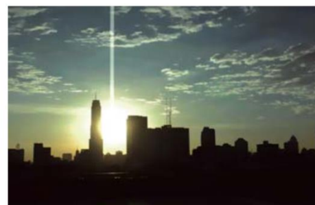
Figure 3. Exemple de smearing et de blooming sur une image prise par un capteur CCD. Le smearing donne lieu à une ligne verticale saturée. Le blooming donne lieu à une saturation des pixels les plus proches.
